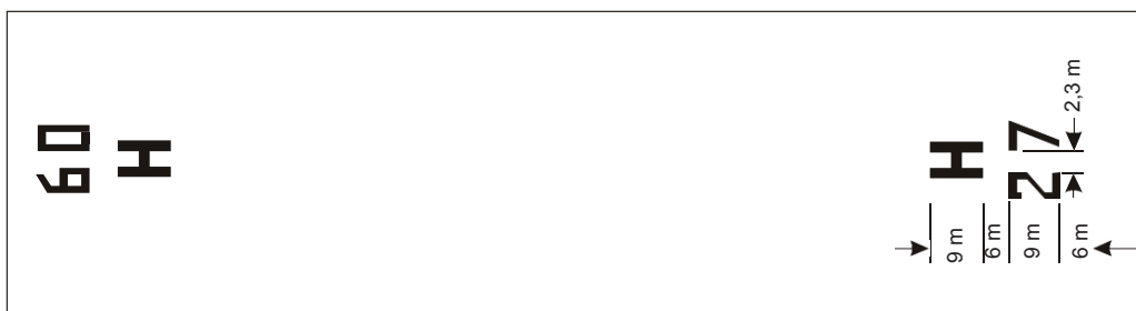
Σχήμα 5-3. Σήμανση διεύθυνσης FATO και σήμανση αναγνώρισης ελικοδρομίου για FATO τύπου διαδρόμου
